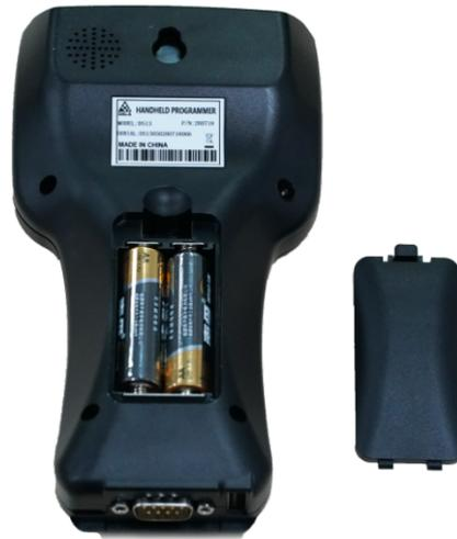
Figure 2.7 DS13 battery compartment
